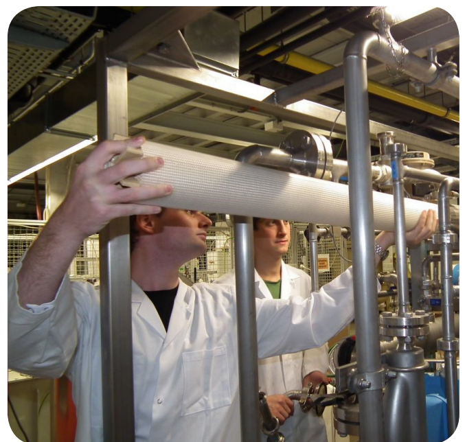
Bestückung der Pilotanlage mit Nanofiltrations Membran
